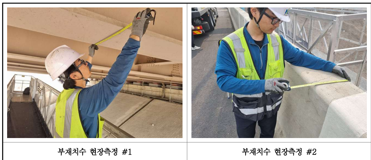
【사진 1.2.1】 부재 현장측정 전경
